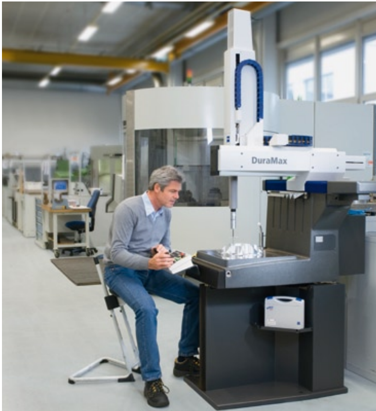
Einfaches Messen: Das Messsystem DuraMax® kann direkt in der Produktion eingesetzt werden. Investitionen für einen speziellen Messraum entfallen.
