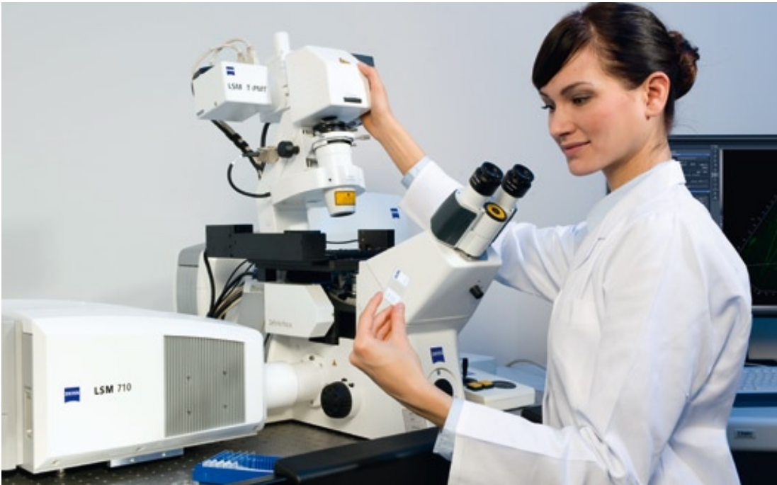
Meilenstein der Mikroskopie: Das LSM 710 ist das erste Mikroskop, das bis zu zehn Fluoreszenzfarben gleichzeitig abbilden kann. Das eröffnet neue Möglichkeiten für die biomedizinische Forschung.
